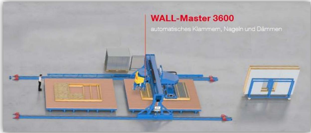
Mit der neuen Maschine aus dem Hause Hundegger können Beplankungen von Holzrahmenbau-Elementen vollautomatisch geklammert und genagelt werden. Zusätzlich können die Gefache mit einer Einblasplatte beflockt werden.
