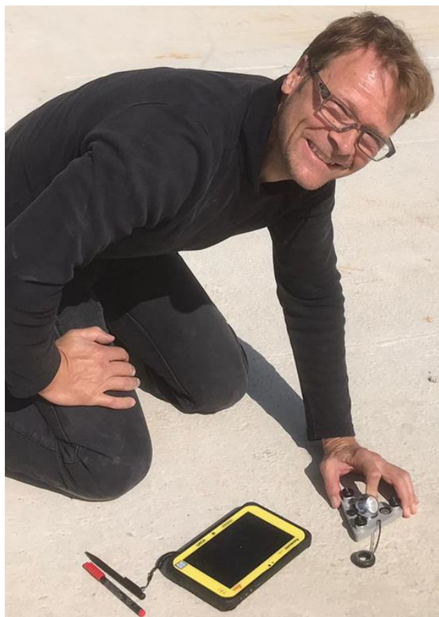
Millimetergenaues Abstecken auf einer Betondecke mit einem Kugelprisma mit Absteckrahmen
