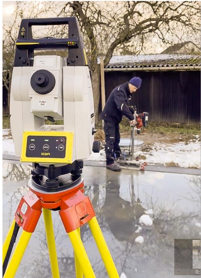
Positionierung des Stexon-Bohrständers mit dem iCR70/iCR80
