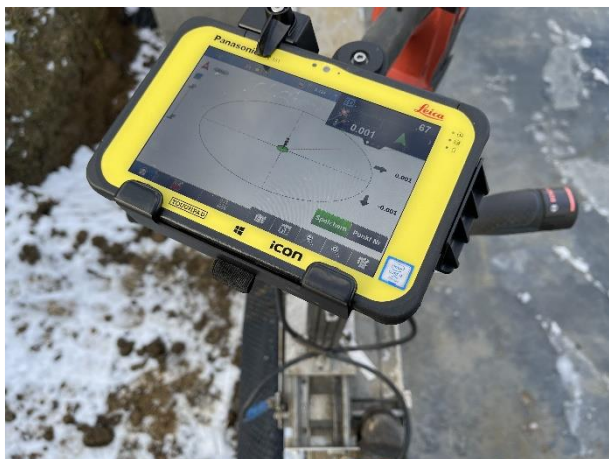
Steuerung des iCR70/iCR80 mit dem Leica Feldrechner
