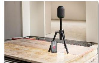
Die einzelnen Scanstandpunkte können mit wenigen Klicks bereits auf der Baustelle auf einem Tablet oder dem Smartphone kontrolliert, ausgerichtet und verknüpft werden. So entsteht Stück für Stück das Gebäude als Punktwolke.
