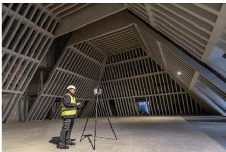
Eine Punktwolke wird von einem 3D Scanner erzeugt, indem sich dieser auf einem Stativ um die eigene Achse dreht und dabei mit einem Laser über einen Spiegel, Millionen von Punkten pro Sekunde erfasst. Die Dauer des einzelnen Scans hängt von verschiedenen Einstellungen ab. Es kann gewählt werden, ob in Farbe oder schwarz/weiß und mit welcher Punktdichte gescannt
