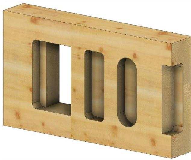
Ist es notwendig, dass Taschen in einer Einbausituation mit einem bestimmten Radius ausgerundet werden müssen, sollten die Taschen bereits im CAD mit diesen Ausrundungen konstruiert werden. In Version 29 können daher "verrundete Taschen" als eigenständige Konstruktionsform für Hundegger BVN und CAMBIUM oder BTL angesteuerte Maschinen manuell definiert werden.
