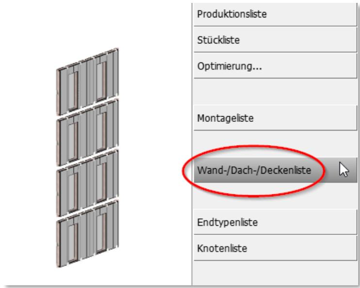
Um die Erkennung identischer Wände durchzuführen, wurde eine neue Listenberechnung eingeführt. Dorthin gelangen Sie im rechten Menü über *Exportieren -> Listen -> Wand-/Dach-/Deckenliste*. Die Berechnung lässt sich entweder für alle Eingblendeten oder nur für aktivierte Elemente durchführen.
