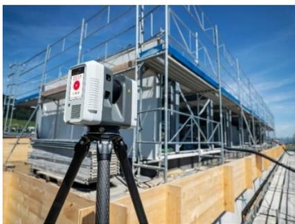
Diese kann in einem entsprechenden Registrierungsprogramm im Büro nachbearbeitet und in ein Dateiformat konvertiert werden, welches von cadwork/Lexocad importiert werden kann.
