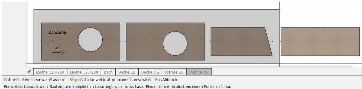
Es ist unerheblich ob die Bauteile bereits geschachtelt sind oder nicht. Werden Bauteile ausgewählt, die den gesamten Inhalt von existierenden Rohlingen ausmachen, werden die existierenden Rohlinge durch die neuen ersetzt. Werden nur Teile vorhandener Rohlinge ausgewählt, werden die betreffenden Bauteile aus den vorhandenen Rohlingen entfernt und in den neuen Rohlingen positioniert.
