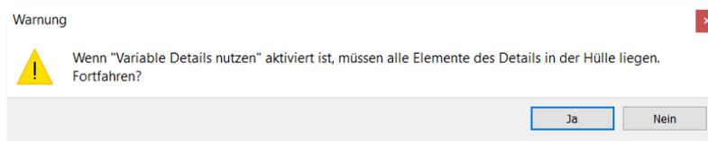
Für das Elementieren mit variabler Dicke ist es zwingend erforderlich, dass die Stärke der Hülle im Detail alle Elemente der Wandzusammensetzung umfasst.
