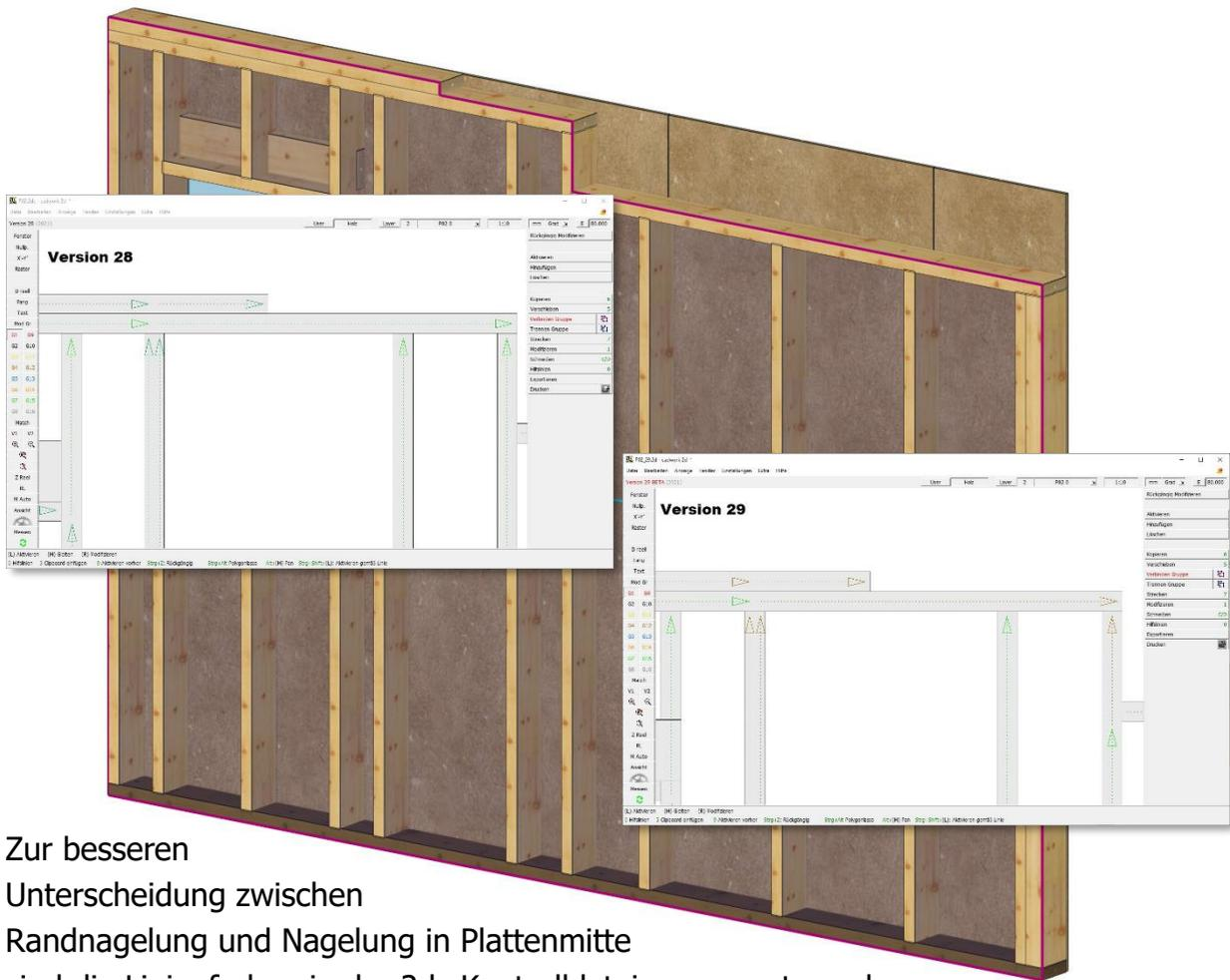
Zur besseren Unterscheidung zwischen Randnagelung und Nagelung in Plattenmitte sind die Linienfarben in der 2dc Kontrolldatei angepasst worden:
