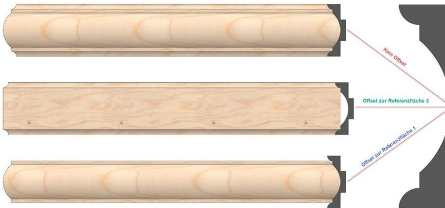
Auf diese Weise können mit nur einer Profilfläche unterschiedliche Werkzeugformen definiert werden, die zu unterschiedlichen Profilierungen führen.
