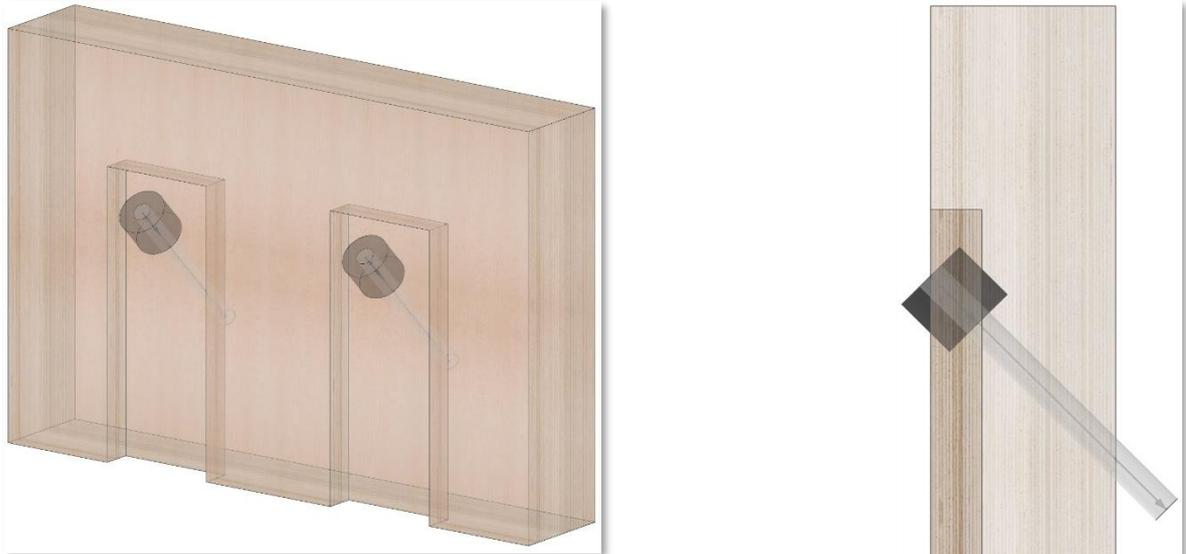
Im Querschnitt der Anschlusssituation wird deutlich, dass kein Schnittpunkt zwischen dem Taschengrund und der Achse der großen Bohrung vorhanden ist. Sofern zur Ausführung des Anschlusses trotzdem eine Bohrung erzeugt werden soll, muss die Option *Einkerbungen berücksichtigen* aktiviert werden. In diesem Fall werden Bohrungen berechnet, sofern eine Durchdringung der Materialisierung des Bohrzylinders mit einem Bauteil vorliegt.
