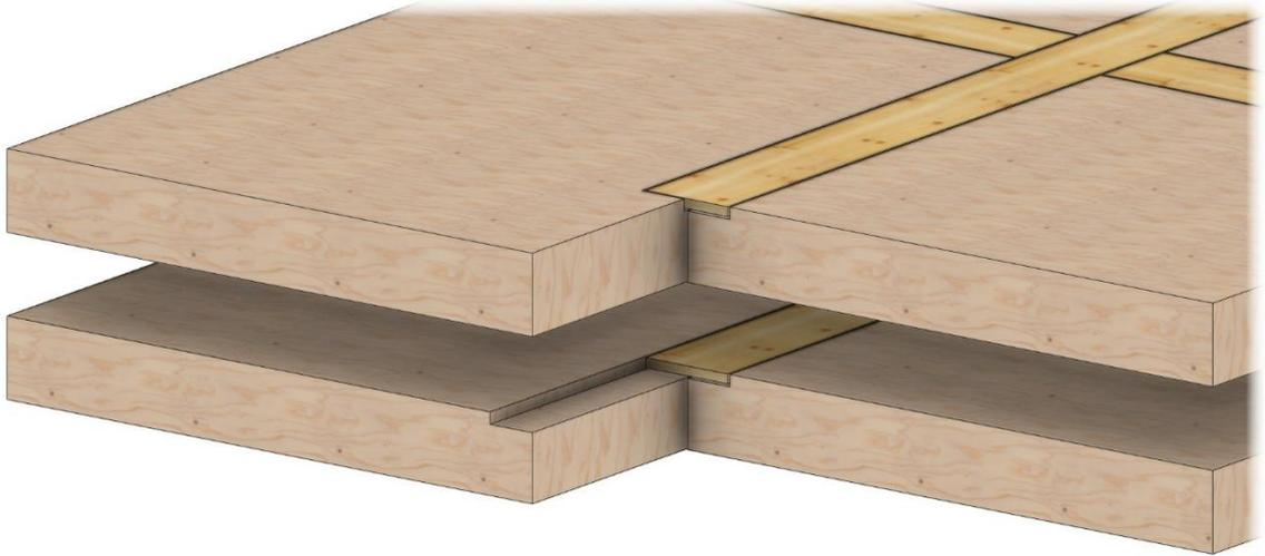
Bei kreuzweise gestoßenen Platten ergeben sich zwei Stoßrichtungen.
