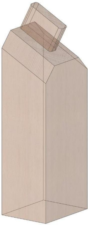
Mit der Option <P> wird der Zapfen rechtwinklig zu seiner Grundfläche abgestirnt. Die Nachbarflächen werden nicht für die Anpassung der Zapfengeometrie herangezogen (hier die zwei seitlichen Fasen). In der Maschinendatenanalyse hat das zur Folge, dass die Fasen nicht über Abschnitte, sondern wie in diesem Fall über zwei Kerben realisiert werden. Die Option kann nicht bei einer negativen Absteckung eingesetzt werden.
