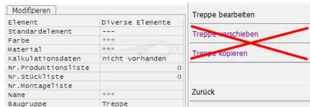
Achten Sie beim Verschieben, aber insbesondere auch beim Kopieren einer Treppe darauf, dass wirklich alle zur Treppe gehörenden Bauteile aktiv sind. Nur dann kann die Treppe nach dem Kopieren als eigenständige neue Treppe modifiziert und bearbeitet werden. Für das nachträgliche Bearbeiten von Treppen ist generell das Modul cadwork Treppe erforderlich.
