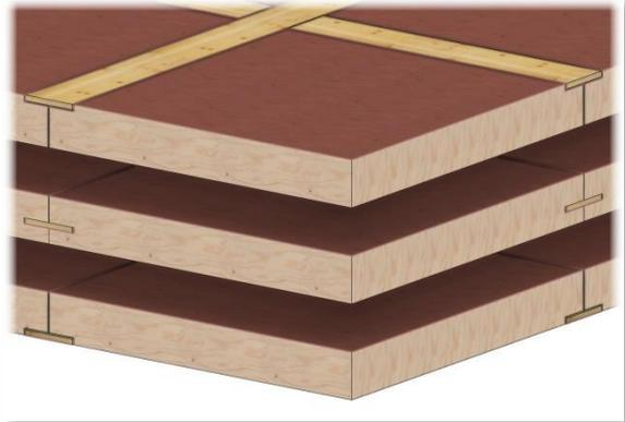
Wurde ein Abstand zur Bund- oder Gegenseite eingestellt, ist es möglich, die resultierende Nut in der Platte mit Hilfe der Option *Herausziehen zur Bundseite/Gegenseite* zum Falz zu schneiden. So ist das Einlegen der Feder von außen möglich.
