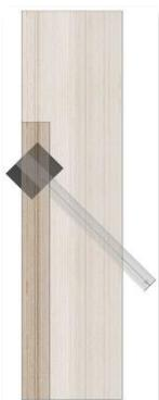
Die Versenkung in dieser Massivholzwand ist als einzelner Bolzen realisiert. Die Achse liegt vollständig in einer Ausblattung, also außerhalb des Bauteilmaterials. Der Bolzen erzeugt lediglich aufgrund seines Radius eine Bearbeitung (Einkerbung) in der Massivholzwand.
