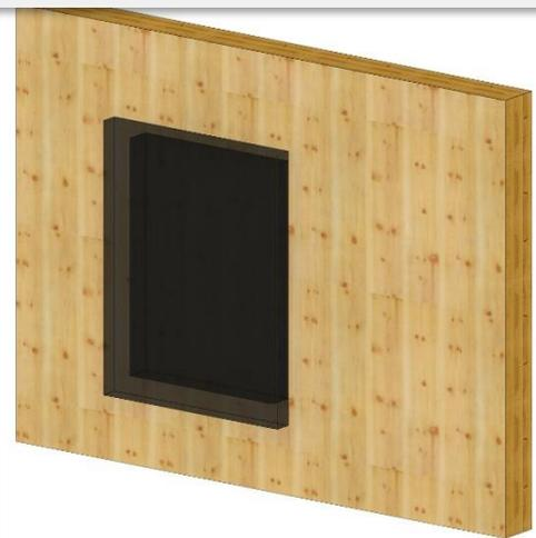
Die als Hilfsvolumen erzeugten Schneidkörper können für eine weitere Verarbeitung genutzt werden.
