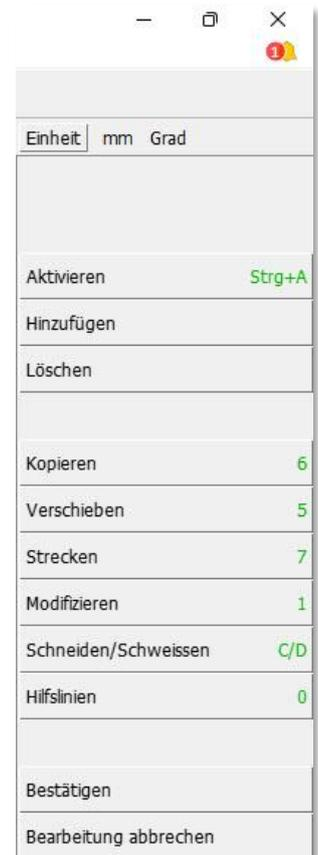
In diesem Modus steht ein rechtes Menü mit leicht veränderten Optionen zur Verfügung. Grundsätzlich stehen alle wesentlichen im cadwork verfügbaren Möglichkeiten zur Veränderung und Erzeugung von Bauteilen zur Verfügung. Der Modus wird beendet über *Bestätigen* oder *Bearbeitung abbrechen*.
