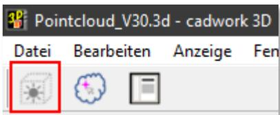
Nachdem der Importprozess abgeschlossen ist, wird die Punktwolke eingeblendet. Diese ist umgeben von der Bounding Box, welche grau und gestrichelt dargestellt wird. Sie kann über das Symbol in der Plugin-Leiste ein- und ausgeblendet werden.
